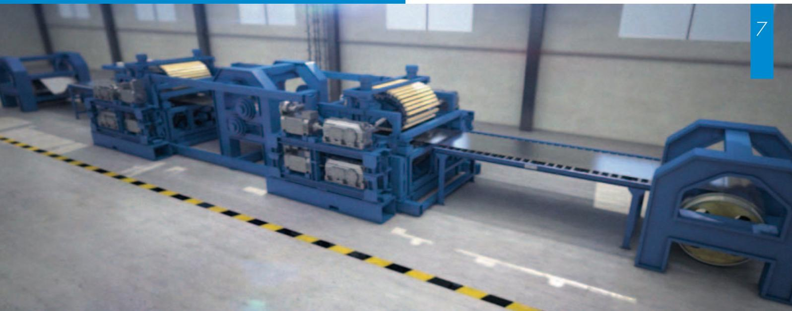
Ein Umlauf-Bridle am Auslauf einer Bandanlage kann den Bandzug auf Null abbauen, das Band bewegt sich zuglos über den Auslauftisch. So schafft das Umlauf-Bridle ideale Bedingungen für die optische Planheitsmessung.
